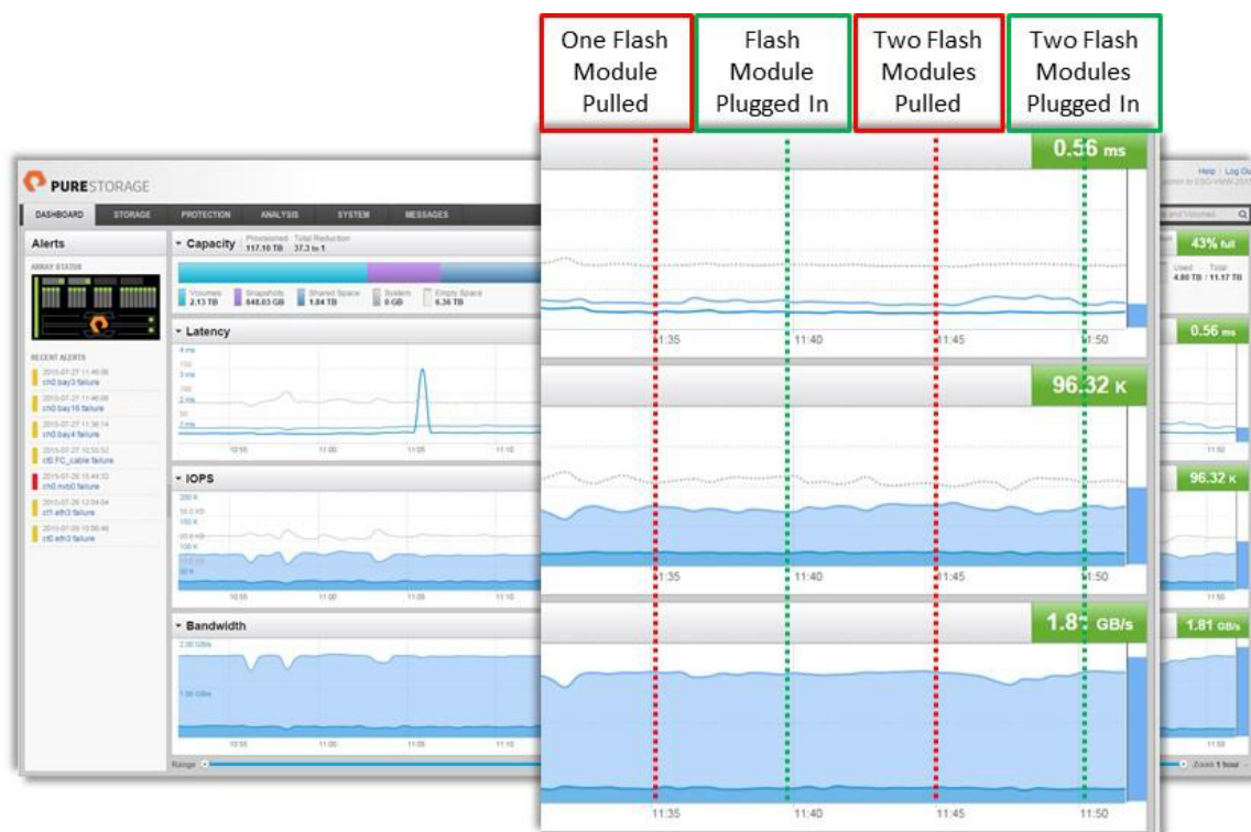
図15: 障害発生テスト(複数のフラッシュモジュールの取り外し)
