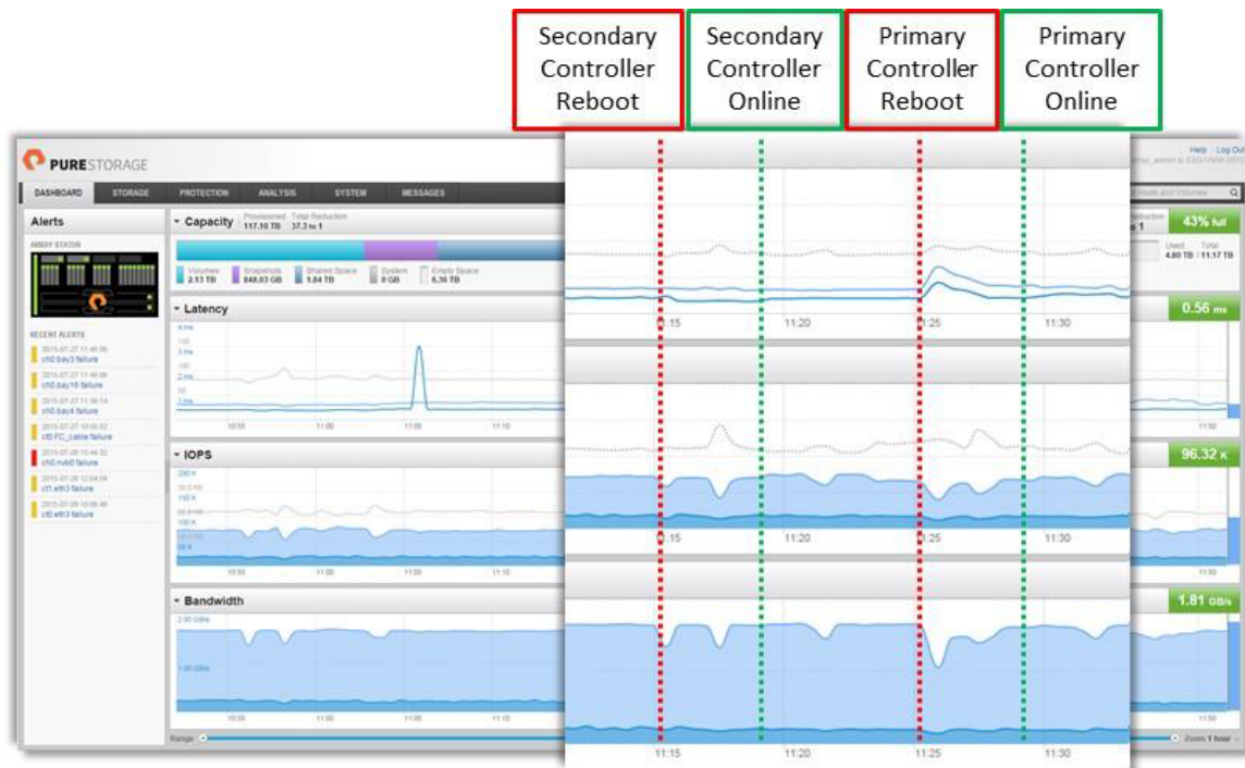
図 14: 障害発生テスト—コントローラー/ソフトウェアアップグレードのシミュレーション
